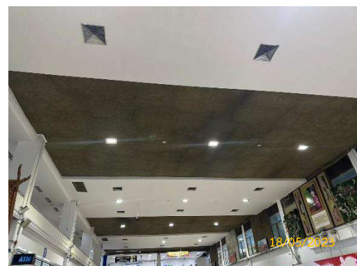
รูปที่ 3-19 บริเวณอาคารผู้โดยสารส่วนที่ติดกับลานจอดอากาศยาน มีการติดตั้งกระจก 2 ชั้น ปูพรม และติดตั้งเพดานยิปซัมบอร์ด เพื่อดูดซับเสียง
